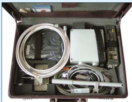
Bild 2: Alle Komponenten finden in einem Aktenkoffer ihren Platz – FT-817, Tastmechanik, Netzteil, Magnetantenne mit Abstimmbox sowie Kabel und Anschlussleitungen.
