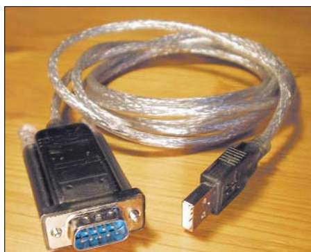
Bild 9: Bei diesem USB-Seriell-Konverter befindet sich die Elektronik im Sub-D-Stecker
