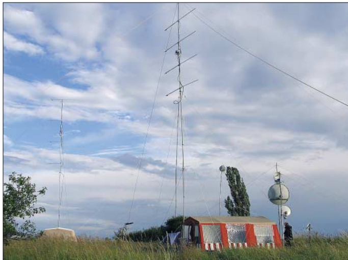
Contestaufbau von DF0YY auf dem Hagelberg (JO62): Im Vordergrund gestocktes Antennensystem für 70 cm sowie weitere Antennen für die SHF-Bänder; im Hintergrund die 2-m-Station mit 4 x 9-Ele.-Yagis vertikal gestockt.
