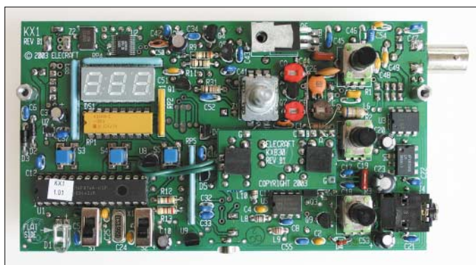
Bild 4: Durch die enge Bestückung konnte man auf die Verwendung von SMD-Bauteilen verzichten.
