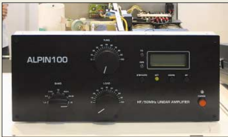
Die PA Alpin100 von Reimesch Kommunikationstechnik macht zwischen 1,8 und 54 MHz 1 kW CW- bzw. 1,3 kW PEP-Output.
