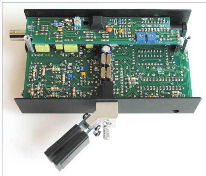
Bild 4: Durch die enge Bestückung konnte man auf die Verwendung von SMD-Bauteilen verzichten.
