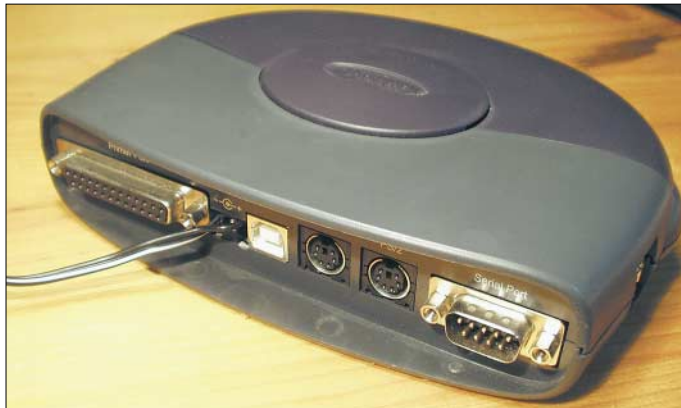
Bild 6: Port-Replikator: Leider keine echte LPT-Schnittstelle
