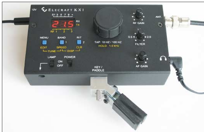
Bild 1: Optionale Paddle-Taste und interner Antennentuner machen aus dem Grundgerät einen universell einsetzbaren Transceiver.
