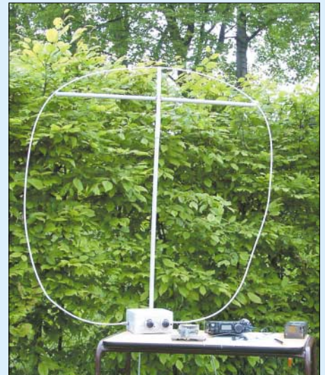
Bild 3: Betriebsfertige Portabelausrüstung mit Magnetantenne
