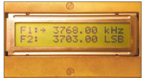
Bild 2: Geändertes LCD-Layout mit Seitenbandanzeige
