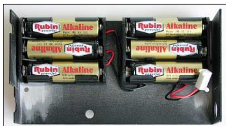
Bild 8: Mit sechs intern untergebrachten Mignon-Zellen sind 1 bis 3 W Ausgangsleistung erreichbar. Fotos: DK3RED
