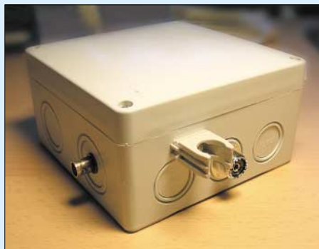
Bild 7: Rückseite des Anpassgerätes, links eine der BNC-Buchsen für die Loop, vorn die Klemmschelle zur Aufnahme des Trägerrohrs
