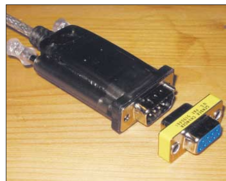
Bild 10: Gender-Changer, z.B. bei Reichelt für 0,69 €
