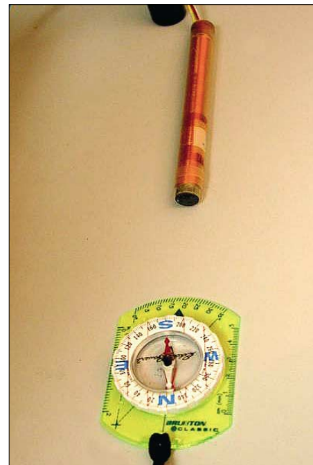
Die Kompassnadel zeigt verschiedene programmierte Magnetfelder. Foto: Dr. Thomas A. Clark
