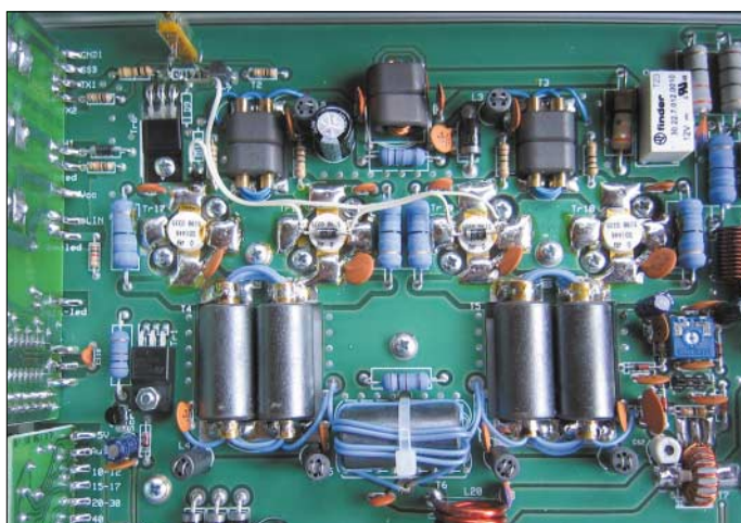
Bild 5: Änderungen im Verstärkerteil – die ursprünglich links oben auf der Platine liegenden Dioden D9 und D10 sind mechanisch auf den PA-Transistoren zu platzieren. Links oben befindet sich jetzt ein Spindelpotenziometer anstelle von R19 .
