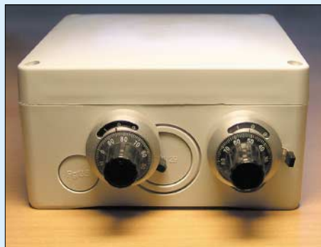
Bild 6: Vorderseite der Anpassbox; deutlich sind die beiden Feintriebe zu erkennen – sie entstammen alten Wendelpotenzio­metern.
