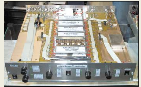
Hohe Spulengüte braucht Platz ... Der neue Preselektor von DFE kann sendeseitig Kilowatt-Signale durchschleifen.
