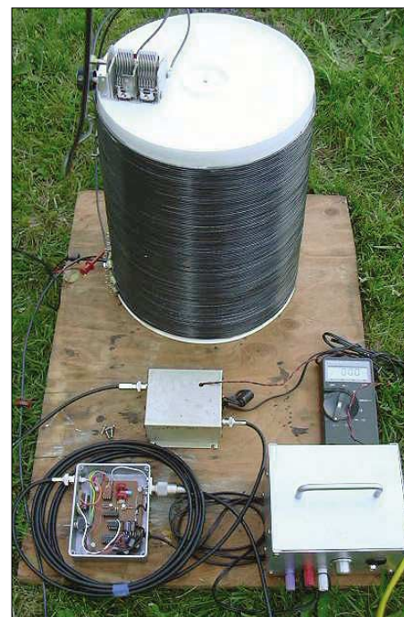
Die Antennenanpassung der LowFER-Bake TIL
