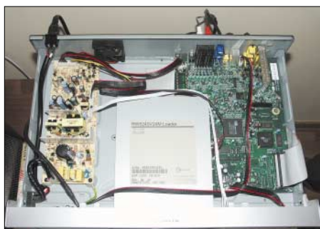
Blick in einen serienreifen DVD-Recorder mit Open-Frame-Schaltenteil links, DVD-Brenner in der Mitte sowie Elektronikbaugruppe mit TV-Tuner, Cirrus-Chips CS98201 und CS92288 rechts
